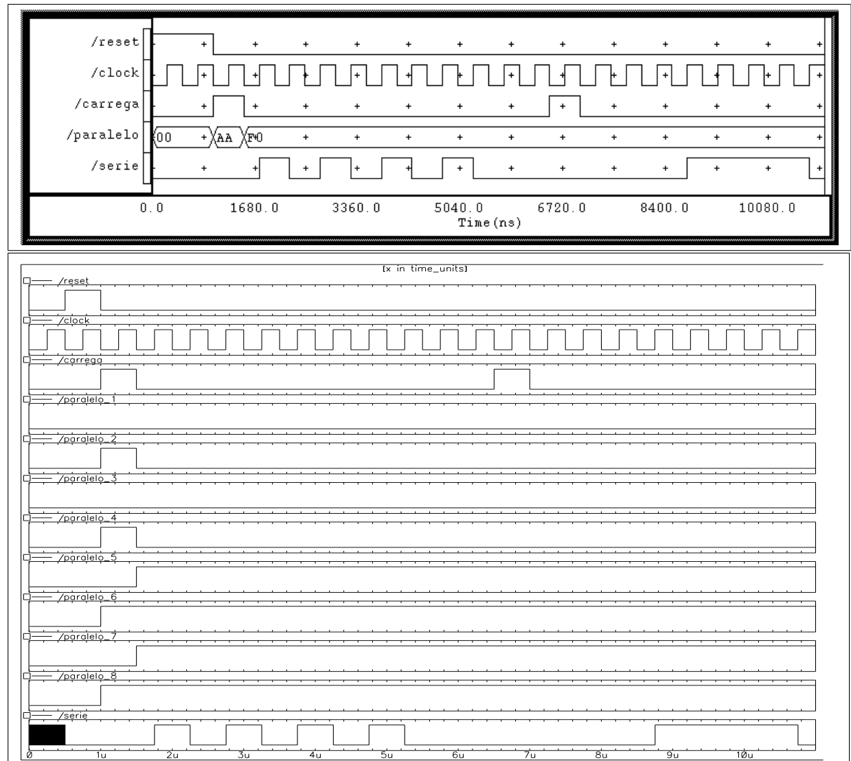
Figura 6.15: Simulação VHDL e lógica do conversor paralelo-série.
