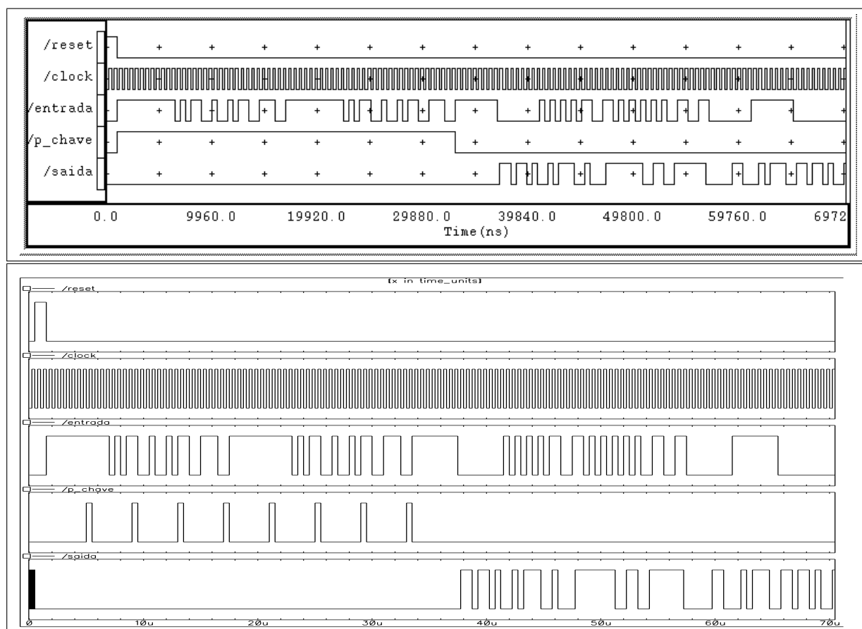
Figura 6.27: Simulação VHDL e lógica do circuito de criptografia.
